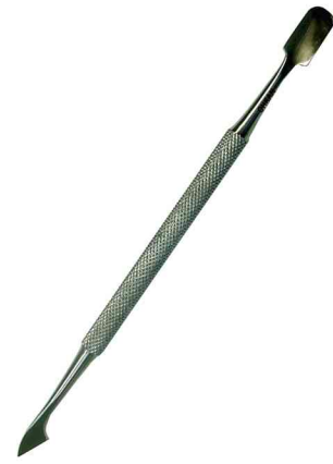
●王冠 プッシャー&カッター 全長：135mm 重量：16g 材質：SUS 304 摘要：グリップ ローレット加工
